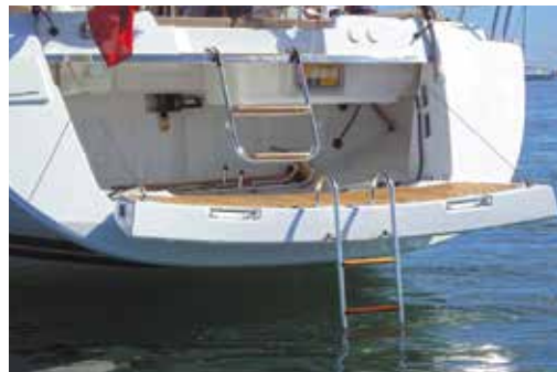
Dinghy garage - Stern platform / Garage à annexe - Plateforme arrière
