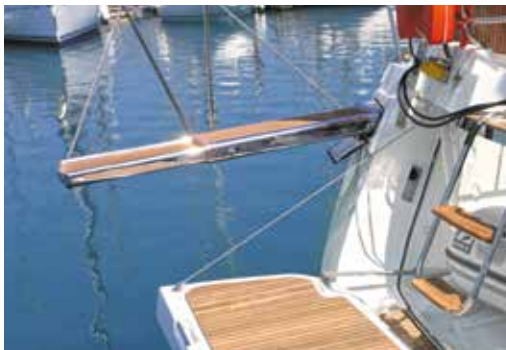
Retractable hydraulic passerelle / Passerelle hydraulique rétractable
